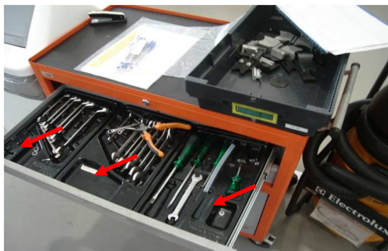
Figura 3.9: Carrinho de ferramental de setup do mecânico desorganizado e sem algumas ferramentas
