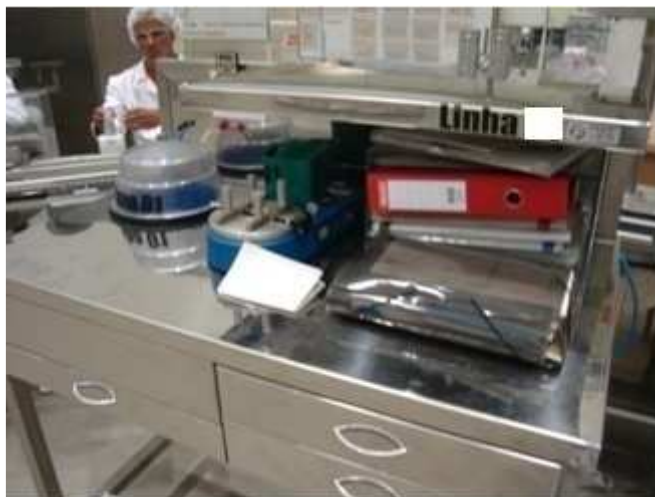
Figura 3.8: Mesa de apoio da Linha 7 - falta de organização com as documentações
